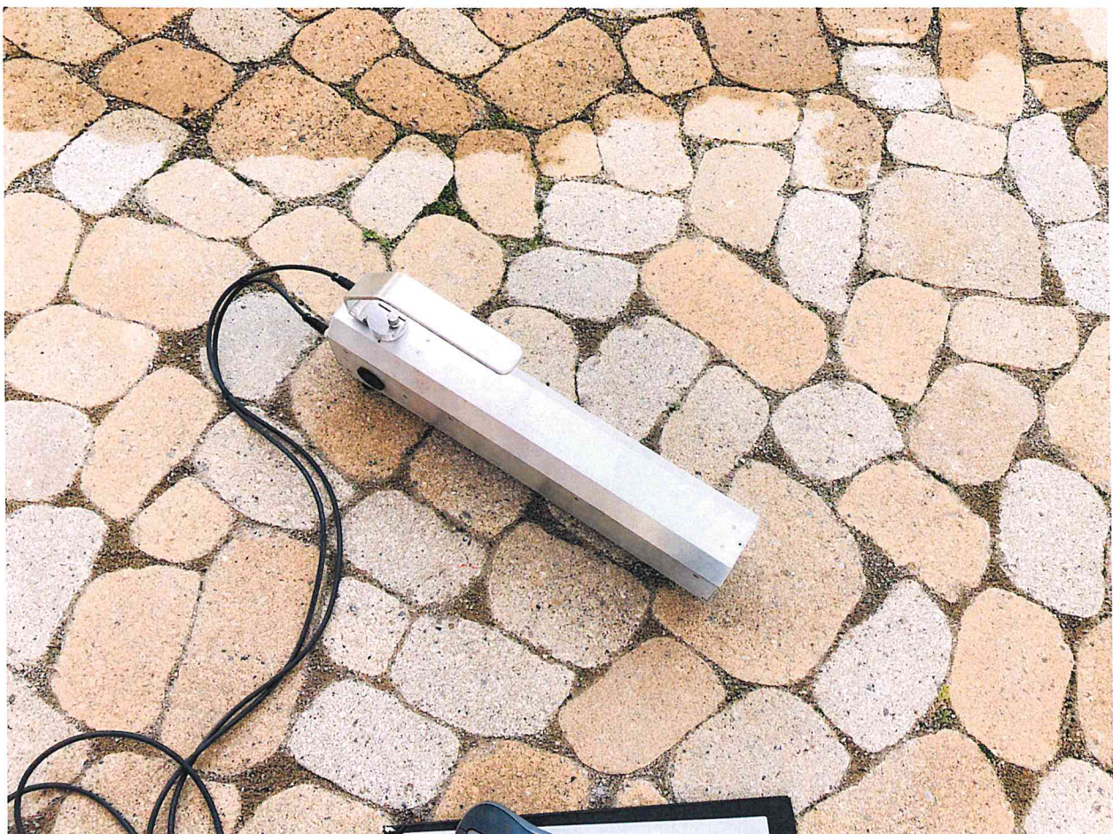
Bild 1. Die Pflasterfläche aus Beton ARENA, wilder Verband mit dem aufgebauten Laser zwecks der Messung der Profilhöhe, hier Aufnahme am 01.10.2020.
